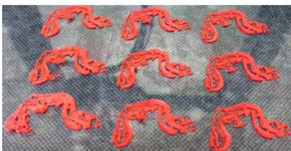
図 2. 印刷に失敗したダイバータ
